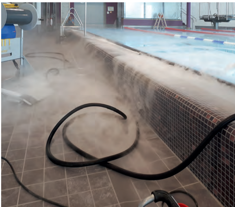
④ Nebelversuch Standard-Luftführung
